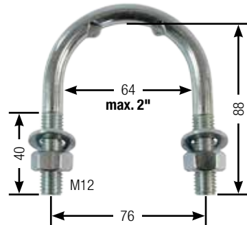
101.1242 Bügelschraube M12 3½" verzinkt, mit Muttern und Scheiben (für z.B. Adapterplatte 101.1240)
