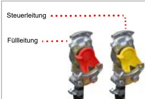
Die Druckluftbremsanlage verbinden Sie über zwei Schläuche mit dem Traktor.
