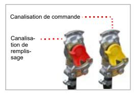
Le système de freinage pneumatique est raccordé au tracteur via deux canalisations.
