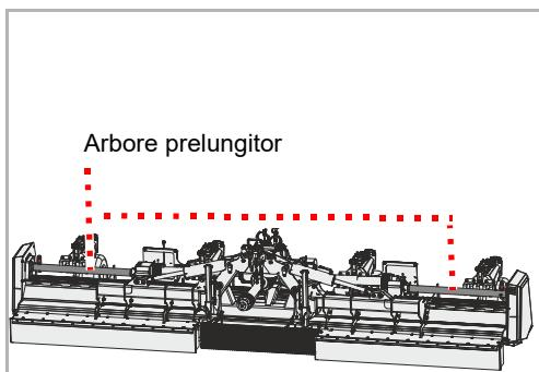
Arboarele prelungitor din stânga și arborele prelungitor din dreapta de pe mașină sunt scufundați în ulei. Uleiul de transmisie trebuie să corespundă specificației.
