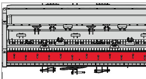
Cu ajutorul unei șine de tăiere se poate modifica gradul de mărunțire. Astfel puteți să determinați cât de fin urmează să fie mărunțit materialul.
