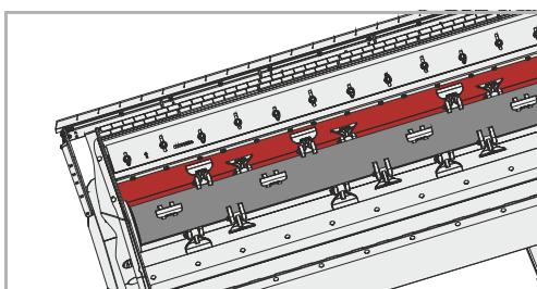
O inserție din Hardox protejează carcasa împotriva uzurii.
