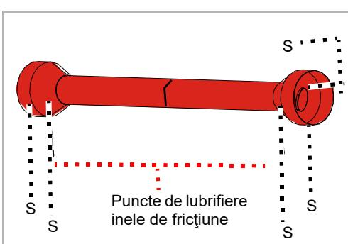
În cazul unui grad de încărcare mare sau în condiții de lucru extreme, ca de exemplu producerea masivă de praf, este necesară o lubrifiere mai frecventă.
