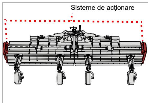
Curelele de acționare sunt tensionate cu un arc. Dacă curelele de acționare nu sunt tensionate suficient, tensionarea trebuie corectată. Dacă există fisuri sau curele de acționare deteriorate, trebuie înlocuite toate curelele de acționare.
