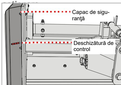
În capacul de siguranță se află un orificiu de control.
