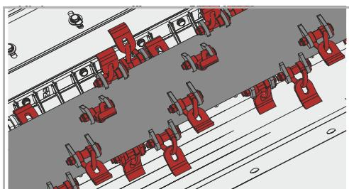
Rotorul pentru cuțite cu verigă în M este utilizat acolo unde se ia în calcul contactul frecvent cu corpuri străine. Veriga oferă cuțitului spațiu liber necesar pentru a evita corporile străine. Acest lucru protejează împotriva deteriorărilor și permite o activitate fără probleme.
