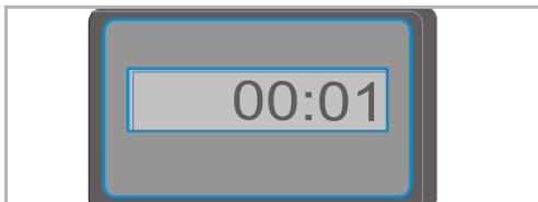
Un contor electronic al orelor de funcționare indică durata de funcționare efectivă. Astfel pot fi înregistrate cu exactitate date și folosite de exemplu pentru calcule.
