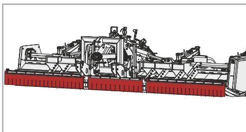
Pentru utilizarea mașinii în zone deosebit de sensibile, poate fi utilă utilizarea unei apărători suplimentare. Apărătoarea suplimentară constă dintr-un dispozitiv de reținere pentru centru și părțile laterale.
